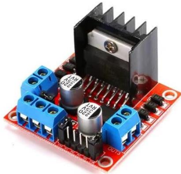
Fig. 9 L298N DC motor drive module
